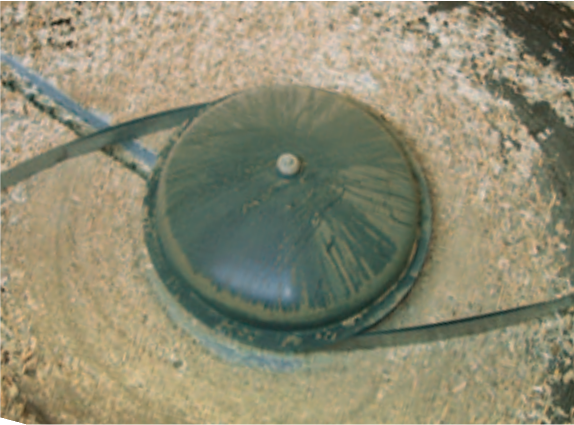
Sistemul HDG de livrare cu lame flexibile este cel mai uzual sistem de livrare. El este potrivit rezervoarelor cu diametre de la 2,5 la 4,5 metri.
