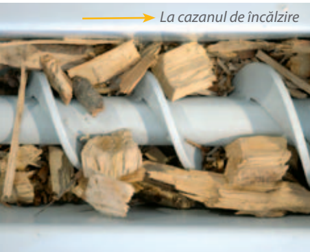
Creșterea progresivă a spiralelor transportorului elicoidal asigură o livrare uniformă și fără probleme a combustibilului
